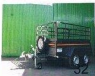
Remolque caja abierta 2400 x 1400 x 600 + 600 Doble eje 900 Kg C/F conjunto 165/70R13 Barandillas desmontables
