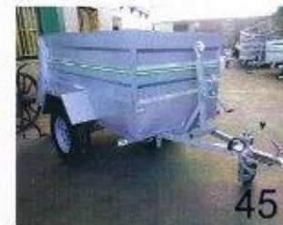
Remolque caja abierta 2000 x 1300 x 800 Eje 1350 Kg S/F Conjunto 235/75R15 Basculante carrucha
