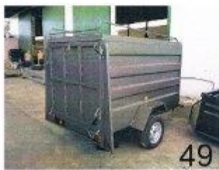
Remolque caja cerrada 2200 x 1300 x 1300 + tapa Eje 750 Kg S/F conjunto 165/70R13
