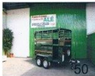
Remolque ganaderos 2600 x 1550 x 1400 + 600 Doble eje 1050 Kg C/F conjunto 185/70R13 Fondo estriado 3/5 Puerta trasera corredera Puerta acceso lateral
