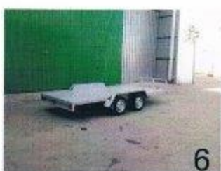
Remolque plataforma uso variado 3500 x 1800 Doble eje 900 Kg C/F conjunto 165/70R13
