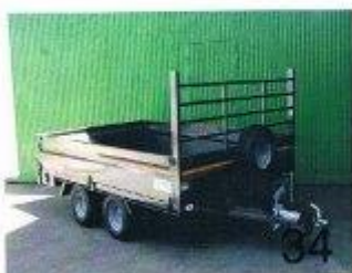
Remolque caja abierta 2800 x 1750 x 500 Abatible Doble eje 900 Kg C/F Ruedas de balón Rueda bajo caja Montacargas delantero
