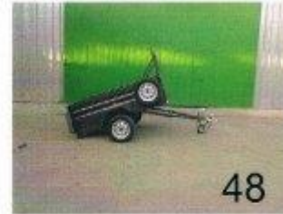
Remolque caja abierta Basculante manual 2000 x 1300 x 500 Eje 750 Kg S/F conjunto 165/70R13
