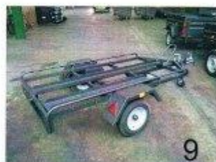
Remolque 1 moto 2000 x 1050 Eje 500 Kg S/F conjunto 135/80R13
