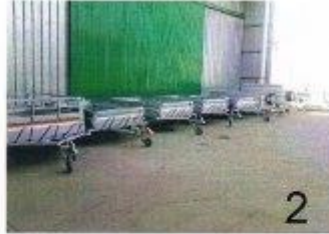
Remolque mixtos moto - carga 2200 x 1400 eje 750 Kg S/F - C/F conjunto 165/70R13
