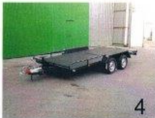
Remolque plataforma portabuggies 3500 x 1750 Doble eje 900 Kg C/F conjunto 165/70R13 Rampas de subida
