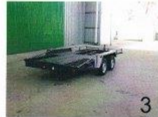
Remolque plataforma 4500 x 2000 Doble eje 1150 Kg C/F conjunto 175/70R14 Rampas de subida
