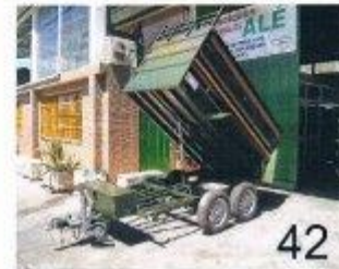
Remolque caja abierta 2500 x 1400 x 700 + 300 Doble eje 1150 Kg C/F Conjunto 185/70R14 Montacargas delantero Basculante eléctrico
