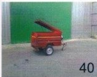
Remolque caja cerrada 1600 x 1050 x 700 + tapa Eje 750 Kg S/F Conjunto 175/70R13
