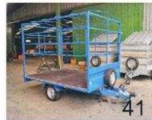
Remolque paquetería 2600 x 1600 x 500 + 1500 Eje 900 Kg C/F Conjunto 165/70R13 Rueda bajo caja
