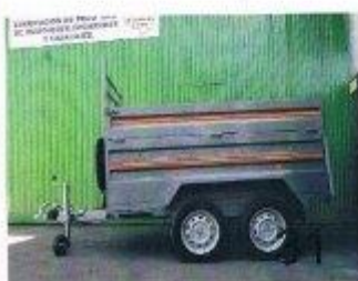
Remolque caja abierta 2400 x 1400 x 700 + 300 Doble eje 900 Kg C/F conjunto 185/70R13 Basculante hidráulico Montacargas delantero
