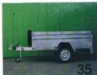
Remolque caja abierta 2200 x 1300 x 500 Eje 900 Kg C/F conjunto 165/70R13
