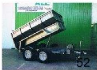
Remolque caja abierta bañera 2600 x 1850 x 900 Doble eje 1350 Kg C/F conjunto 235/75R15 Basculante hidráulico y eléctrico
