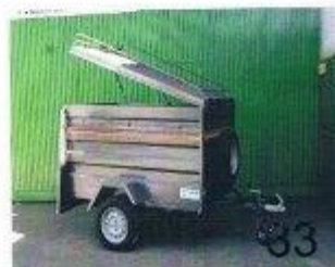
Remolque caja cerrada 2000 x 1300 x 1000 + tapa Eje 900 Kg S/F conjunto 165/70R13
