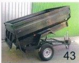
Remolque caja abierta bañera 2200 x 1300 x 700 + 300 Eje 1350 Kg C/F Conjunto 235/75R15 Basculante hidráulico
