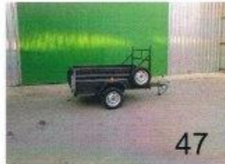
Remolque caja abierta Basculante manual 2000 x 1300 x 500 Eje 750 Kg S/F conjunto 165/70R13
