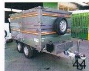
Remolque caja abierta 2800 x 1800 x 500 + 500 Doble eje 1350 Kg C/F Conjunto 185/70R14 Basculante hidráulico y eléctrico
