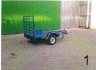
Remolque porta-quads 2200 x 1400 x 1100 eje 750 Kg S/F conjunto 165/70R13
